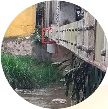
Estación Hidroclimatológica de niveles Bocas, se encuentra ubicada en el municipio de Girón. Hace parte de la Red Hidroclimatológica de la CDMB. Permite el registro de las variaciones en los niveles de columna de agua para esta sección del río.
